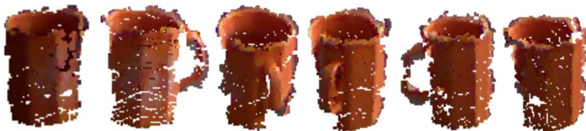
Fig. 3.1 Diferite perspective de vizualizare ale unei căni, reprezentate sub forma unor nori denși de puncte 3D.
