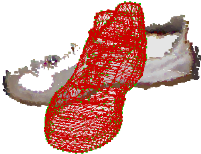
Fig. 4.6 Suprapunerea centrelor de greutate ale norilor de puncte ce înfățișează o primitivă generică ( \mathcal{P}^M ), respectiv un nor de puncte obiect ( \mathcal{O}_k ). Pentru o vizualizare mai elocventă, \mathcal{P}^M este reprezentat sub forma unei rețele triangulare de puncte (linii de culoare roșie).
