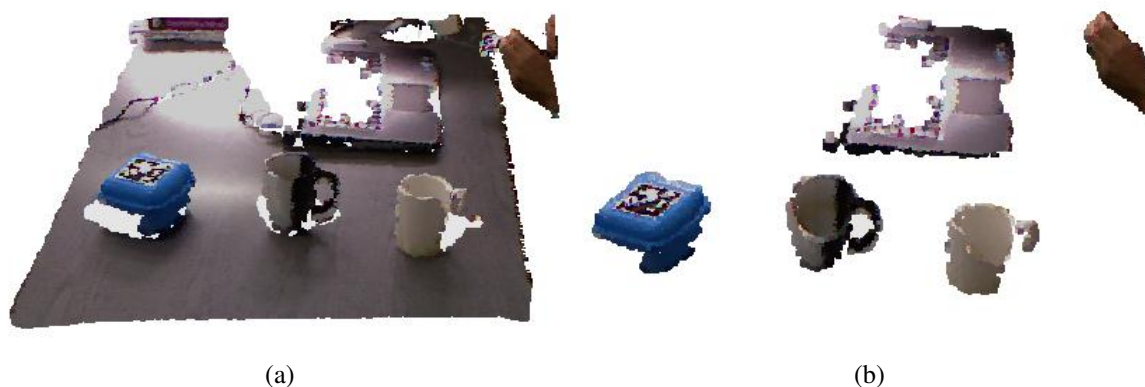
Fig. 2.17 Segmentarea prin partiționare a norilor de puncte: (a) nor de puncte inițial; (b) grupuri de puncte segmentate.
