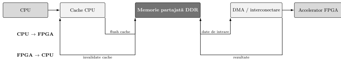
Figura 9.12 Accesul CPU și FPGA la o memorie partajată.
