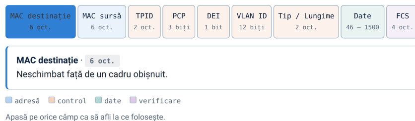
Figura 4.2 Cadrul etichetat 802.1Q, câmp cu câmp.
