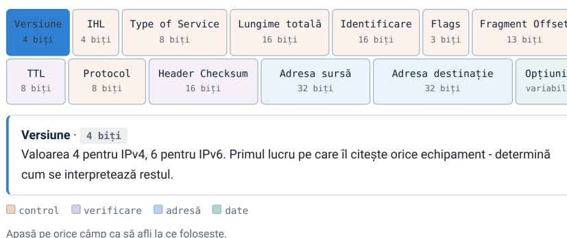
Figura 5.2 Antetul IPv4, câmp cu câmp.
